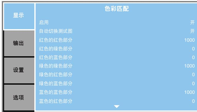
每个投影机或应用可能需要独一无二的色域（范围），或者可能需要为多个临近的显示屏精确地匹配颜色。通过仪器调整或手动调整进行颜色匹配，指定每个主要颜色组成（红色、绿色、蓝色和白色）的精确色调。每种颜色的x/y坐标确定其在标准CIE色度图中的位置。更改一个或两个数字将改变颜色的色调，并修改颜色的范围。例如，更改红色的x/y坐标可能会使颜色更加接近橙色或者接近紫色，进而影响包含红色分量的所有显示颜色。根据需要调整滑杆或输入新坐标，以确定或更改环境和应用所需的色域。
